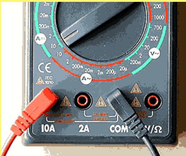
figura 5 - collegamento dei puntali per misure di corrente fino a 10 A.
