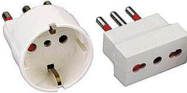
Figura 3 - Adattatori: quello a sinistra per collegare una spina tedesca ad una presa italiana da 16 A; quello a destra consente di collegare ad una presa da 16 A una spina italiana sia da 16 A che da 10 A
