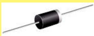
Figura 2 - Diodo: l'anello in colore chiaro indica il lato da cui la corrente esce (catodo)
