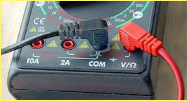
figura 3 - collegamento dei puntali per le misure di tensione e resistenza.
