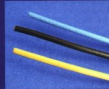
Schritt 5: Jetzt haben wir die drei farblich isolierten massiven Kupferdrähte einzeln vor uns liegen. Mit Isolierung besitzen die Adern jeweils einen Durchmesser von etwa 3,2 mm. Eventuelle Talgreste wischen wir einfach ab.
